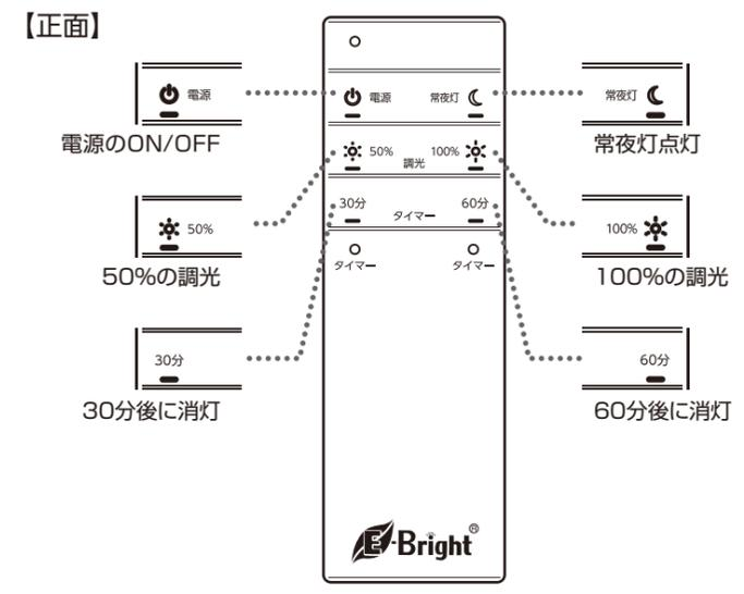
タイマー設定をすると照明器具本体から「ピッ」と音がし、タイマー設定を解除すると照明器具本体から「ピッ、ピッ」と2回音がします。
