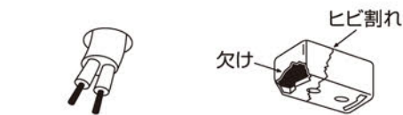
【配線だけのもの】 【破損しているもの】
