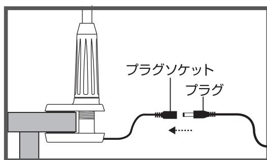
付属の専用ACアダプターのプラグをクランプの背面から出ているプラグソケットに差し込みます。(左図参照)
