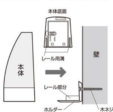
※壁面の材質により、木ネジが効きにくい場合は付属の木ネジ用アンカーを適時ご利用ください。
