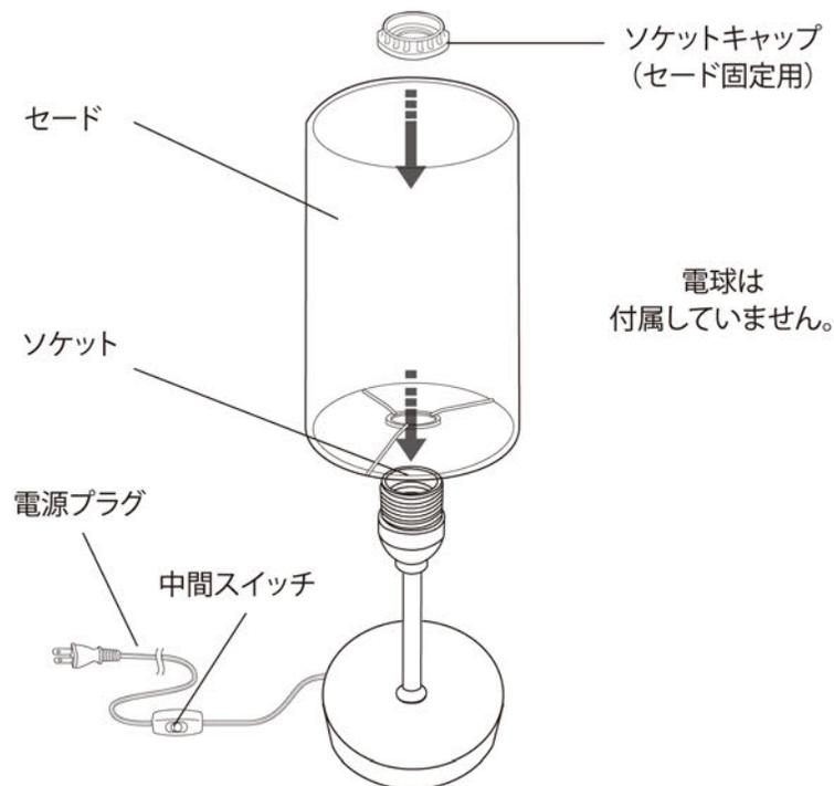
■定格:100V 50/60Hz共用 ■消費電力:40W(一般白熱電球使用時)
