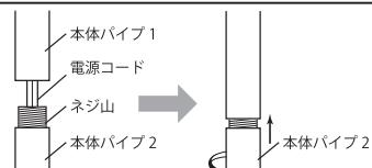
本体パイプ1を持って本体パイプ2のネジ山に合わせ、本体パイプ2を反時計まわりに回し、最後まで締めます。
