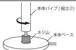
本体パイプの中の電源コードのねじれを軽減するために、組立てた本体パイプを反時計まわりに10回ほど回します。
