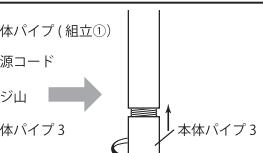
①で組立てたパイプを持ち、本体パイプ3のネジ山に合わせ、本体パイプ3を反時計まわりに回し、最後まで締めます。
