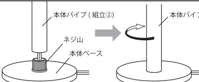
組立後の本体パイプを本体ベースのネジ山に合わせ、本体パイプを時計まわりに回し、最後までしっかりと締めます。
