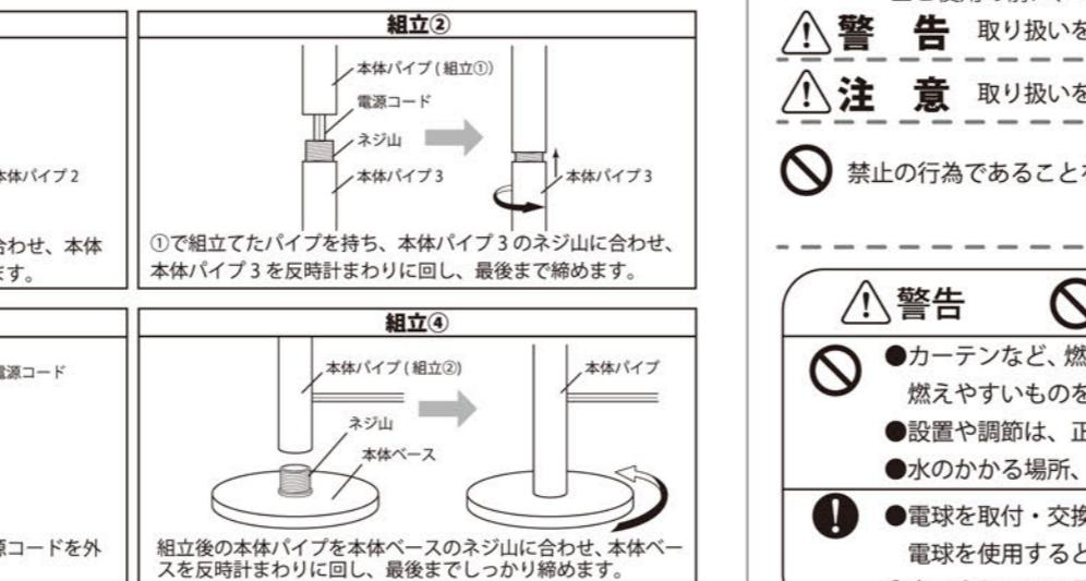
①で組立てたパイプを持ち、本体パイプ3のネジ山に合わせ、本体パイプ3を反時計まわりに回し、最後まで締めます。
