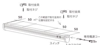
※天井や壁等への取付の際は落下防止のため取付金具が確実に固定されている事を必ずご確認ください。また定期的に固定状態を確認してください。
