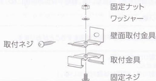
※壁面への取付の場合は、壁面取付金具を取付金具とセットしてご使用ください。
