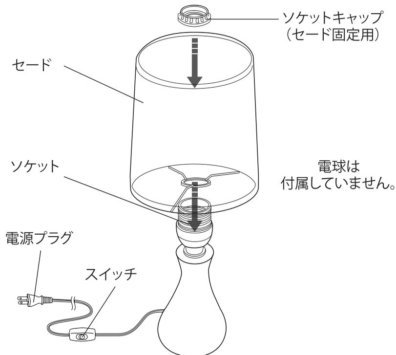
■定格電圧:AC100V 50/60Hz共用 ■消費電力:40W(一般白熱電球使用時)
