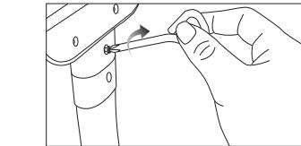
③ ドライバーでネジを取り付けて、セードを固定します
