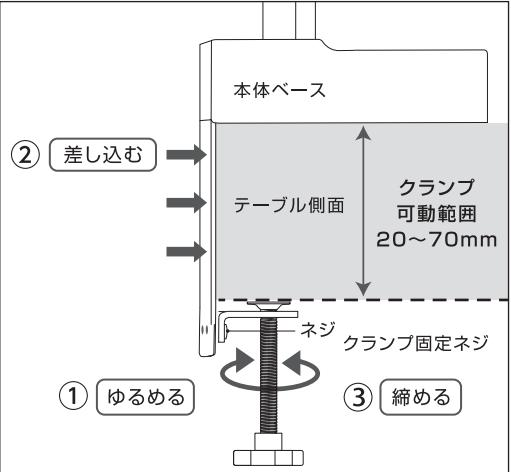
①「クランプ固定ネジ」を時計回りに回してゆるめます。
