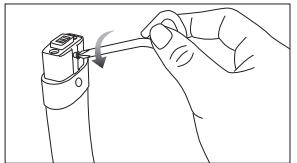
① ドライバーでネジを外します。
