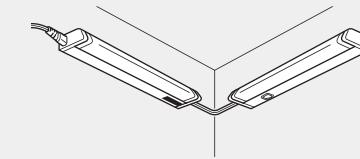
※ 急角度での連結はコードの破損につながりますので、無理な条件下では行わないでください。
