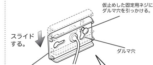
(3) 二つの取付ベースがまっすぐになるか確認し、仮止めした固定用ネジを締め付ける。
