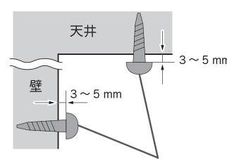
※固定用ネジの取付ピッチは「取付寸法図(3ページ)」を参照してください。
