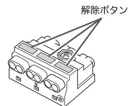
(3) 余分な電源線、アース線を電源穴に押し込む。
