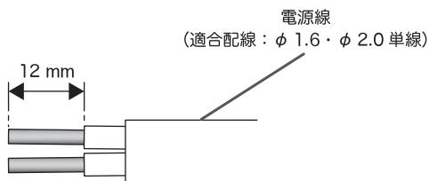
(2) 電源線、アース線を接続端子台の極性表示に従い、図のように確実に差し込む。
