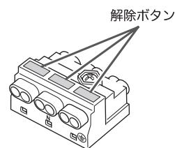
(3) 余分な電源線、アース線を電源穴に押し込む。
