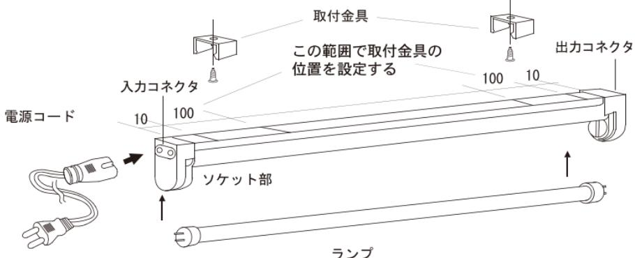
※天井や壁等への取り付けの際は落下防止のため取付金具が確実に固定されている事を必ずご確認下さい。また定期的に固定状態を確認して下さい。
