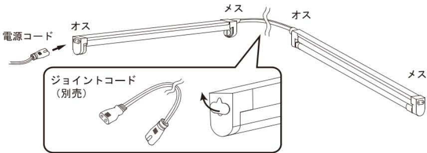
コネクタカバーを取り外しジョイントコードを使用し連結します。
