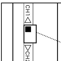
リモコン信号の送信チャンネルを設定します。器具本体側も設定します。
