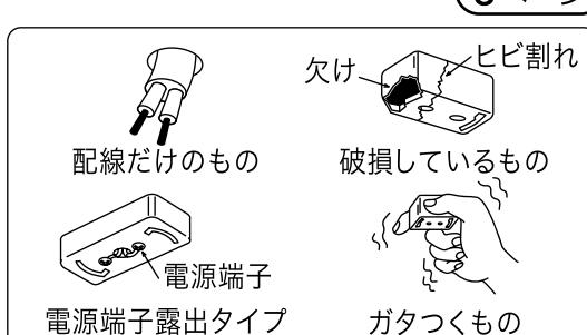
●器具を改造したり、部品交換したりしない。火災、感電、落下によるけがのおそれがあります。
