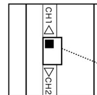
リモコン信号の送信チャンネルを設定します。器具本体側も設定します。照明器具を2台使用する場合など器具ごとにCH1とCH2で分けることができます。
