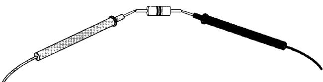
回路内の抵抗測定は、必ず機器（回路）の電源を切って回路内のコンテンツが放電した後、測定してください。
