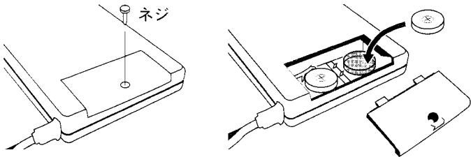
**△ 注意** 電池交換の時に、付属のテスト棒を使って電池を取り出す事は絶対にしないでください。ショートして本器の故障の原因となります。
