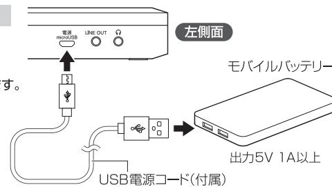
●付属のUSB電源コードは本製品専用です。本製品をご使用の際には必ず付属のUSB電源コードをお使いください。また、付属のUSB電源コードは絶対に他の製品には使用しないでください。製品の破損、もしくは火傷・発煙・火災の原因となる場合があります。
