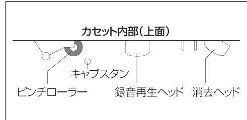
ヘッドの消磁を行うには市販の消磁器をお使いください。カセットタイプの消磁器を使いになるとときは、必ず再生ボタンのみを押し込んで消磁してください。詳しくはヘッド消磁器の説明書をご覧ください。
