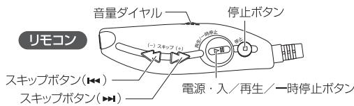
電源入切、再生、一時停止、停止、音量、スキップ(◀◀/▶▶)は、本機、リモコンのどちらでも操作できます。
