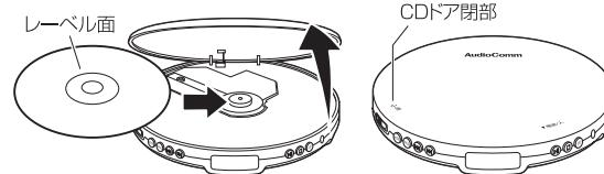
**2** ディスクのレーベル面(印刷している面)を上にして正しくセットした後、CDドア閉部を指先で押して閉めます。
