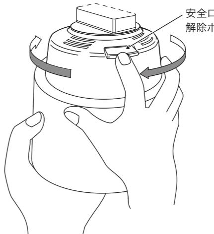
④「カチッ」と音がするまで上図のように右へ回して取り付ける。
