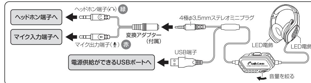
※LED電飾はUSB端子を正しく接続し、通電した時点で赤く点灯します。
