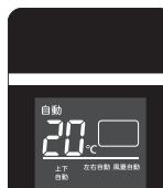
運転入／切ボタンを押すと、前回電源を切った状態で電源が入ります。もう一度押すと電源が切れます。
