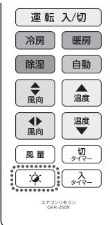
バックライトボタンを押すと、ボタン操作に応じてディスプレイのバックライトを点灯させるかしないかの設定ができます。同ボタンを押すたびに、ONとOFFが切り換わります。
