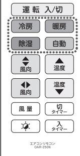
自動、冷房、暖房、除湿のいずれかのボタンを押すと、その運転モードに切り換わります。
