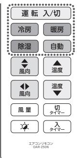
運転入／切ボタンを押すと、前回電源を切った状態で電源が入ります。もう一度押すと電源が切れます。
