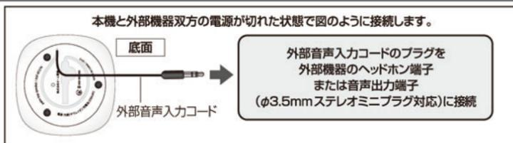
**1** 外部機器の電源を入れ、本機の電源スイッチを「AUX IN」に合わせます。「AUX IN」に合わせると電源ランプが青く点灯します。
