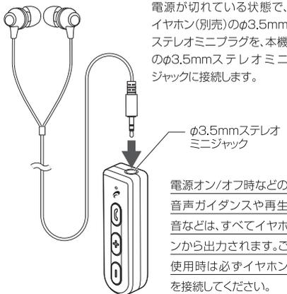
電源が切れている状態で、イヤホン(別売)のφ3.5mmステレオミニプラグを、本機のφ3.5mmステレオミニジャックに接続します。
