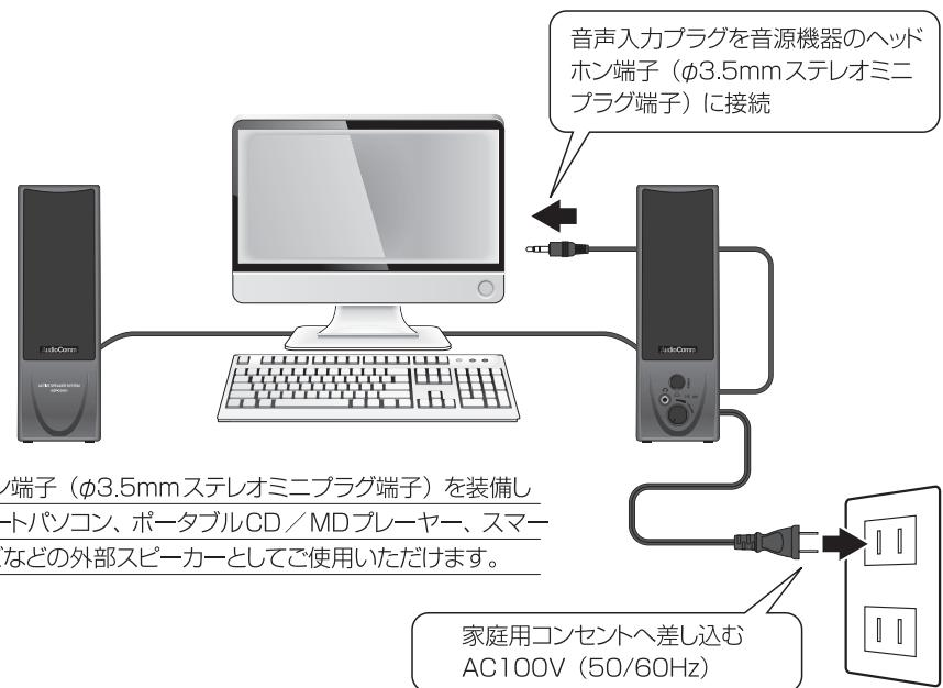
音声入力プラグを音源機器のヘッドホン端子 (φ3.5mmステレオミニプラグ端子) に接続
