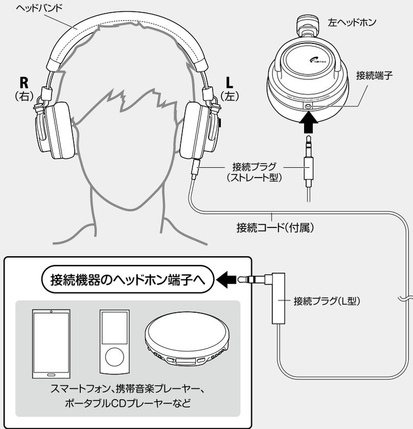
**1** ヘッドホンの接続端子に、付属の接続コードのプラグ(ストレート型)を差し込みます。その後、接続機器の音量を絞った状態で、機器のヘッドホン端子に本機の接続プラグ(L型)を差し込みます。音量を絞らないでプラグを差し込むと、本機の故障や耳への障害につながるおそれがあります。
