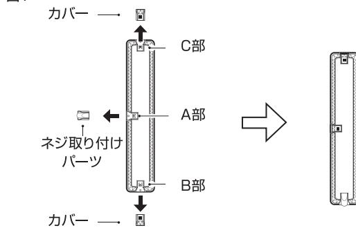
①図1のように、ランプA部のネジ取り付けパートとB部(またはC部)のカバーを取り外します。
