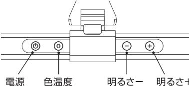
⑥明るさ、色温度、角度を調節します。(図4・図5)
