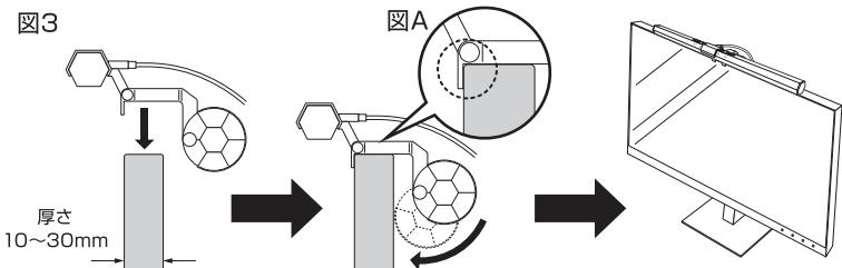
③図3のように、クリップをつけたランプをモニターフレームの上部に置いてください。図Aのように、ベゼルの上部はクリップと密着し、隙間がないように取り付けてください。
