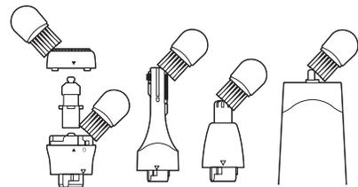
※ポディーシェーバーヘッドは、▼と▲マークを合わせて引き抜くと上下に分かれます。さらに中の回転軸を取り出してお手入れをしてください。また、お手入れ後は、確実に元どりに組み立ててください。
