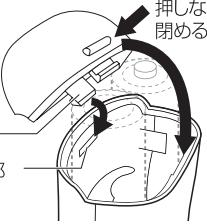
電池カバーを閉めるときは、乾電池の上からカバーを押し込むようにして、確実に固定してください。
