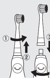
ブラシ部を矢印の方向に回し(①)、引き抜いてください(②)。新しいブラシを取り付けるときは、ブラシ取付軸の凹凸と新しいブラシの取付部の凹凸を合わせて差し込み(③)、元の位置まで確実に回してください(④)。
