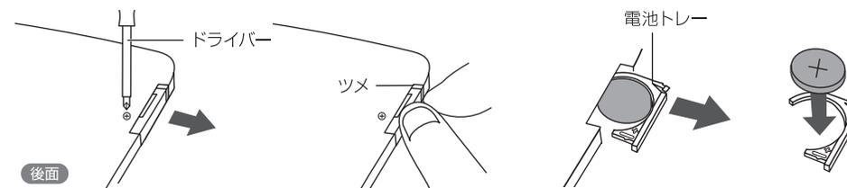
細い+ドライバーでねじを緩めてください。電池トレイのツメの部分を中心に横に押しながらかき出してあげてください。新しい電池をトレイにセット(電池の+と本体に表示されたマークを同じ面にします)し、しっかり差し込んでねじを締めます。
