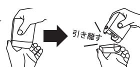
5. 削りくずを捨てたら、必ずくずケースを元の位置に確実にセットしてください。
