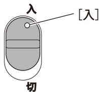
③ 電源スイッチを[切]にし、電源プラグをコンセントから抜く。
