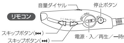
電源入切、再生、一時停止、停止、音量、スキップ(◀◀/▶▶)は、本機、リモコンのどちらでも操作できます。
