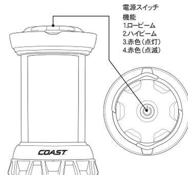
スイッチをもう一度押す(計2回目)と、白色 LED の「高」出力モードに切り替わります。スイッチをもう一度押す(計3回目)と、赤色 LED の「点灯」モードに切り替わります。スイッチをもう一度押す(計4回目)と、赤色 LED の「点滅」モードに切り替わります。ランタンを OFF にするには、電源スイッチを最後にもう一度(計5回目)押します。
