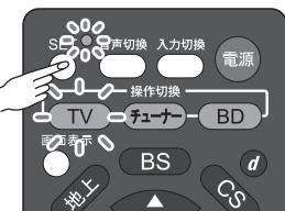
2 停止ボタンを押しながら、消去したい機器の操作切換ボタンを押します。
