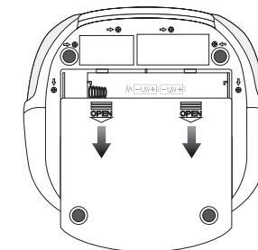
●本体底面にある電池カバーのOPEN部を押しながら、矢印の方向にスライドさせて開けます。
