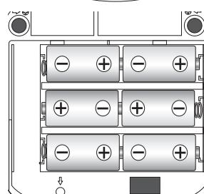
●乾電池の向きを図のように正しく入れてください。コイルばねのあるほうが+です。+側から先に装着してください。
