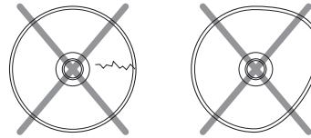
◆再生中、ディスクはプレーヤー内で高速回転しています。ひびやそりのあるディスク、割れたり変形したディスク、テープや接着剤で補修したディスクなどは危険ですから絶対に使わないでください。
