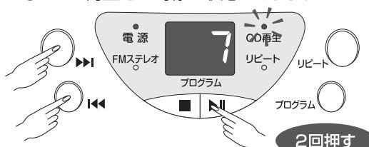
4 カセットの録音ボタンを押し、すぐにCDの再生／一時停止ボタンを押します=録音開始
