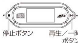
**電源オン**…再生/一時停止ボタンを押すと、電源が入ります(CDが正しく装着されているときは、読み込み動作の後、自動的に再生が始まります)。
