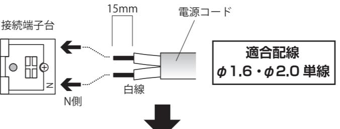
2. 接続後、電源コードを接続端子台ボックスカバーの穴から出したまま、接続端子台ボックスカバーをスライドさせて本体の凹部と接続端子台ボックスカバーの凸部を合わせて取付けてください。
