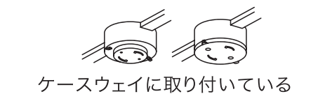
電源端子露出タイプ 電源端子 ガタつくもの
