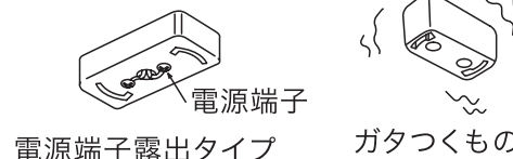
配線だけのもの 欠け ヒビ割れ 破損しているもの
