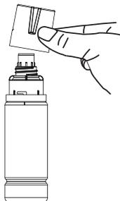
3. プリンターカバーを開け、インクボトルと同じ色のタンクキャップを開けます。
