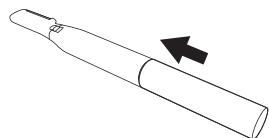
●必ずアルカリ乾電池をご使用ください。マンガン乾電池は電池容量が小さく、本製品には向きです。
