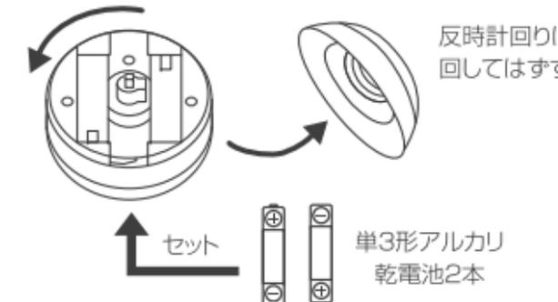
2.電池のフタのロック表示に合わせ、確実に閉めてください。
