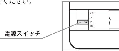
4. 「電源スイッチ」を「入」の位置にして、細断する紙を「紙投入口」にまっすぐ投入してください。「オートスタートスイッチ」が感知し、自動的に細断が始まります。
